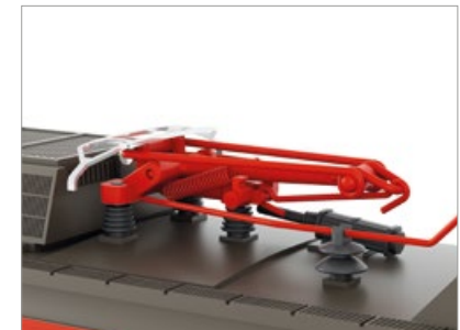
■ Filigrane Stromabnehmer mit innovativer Befestigung
