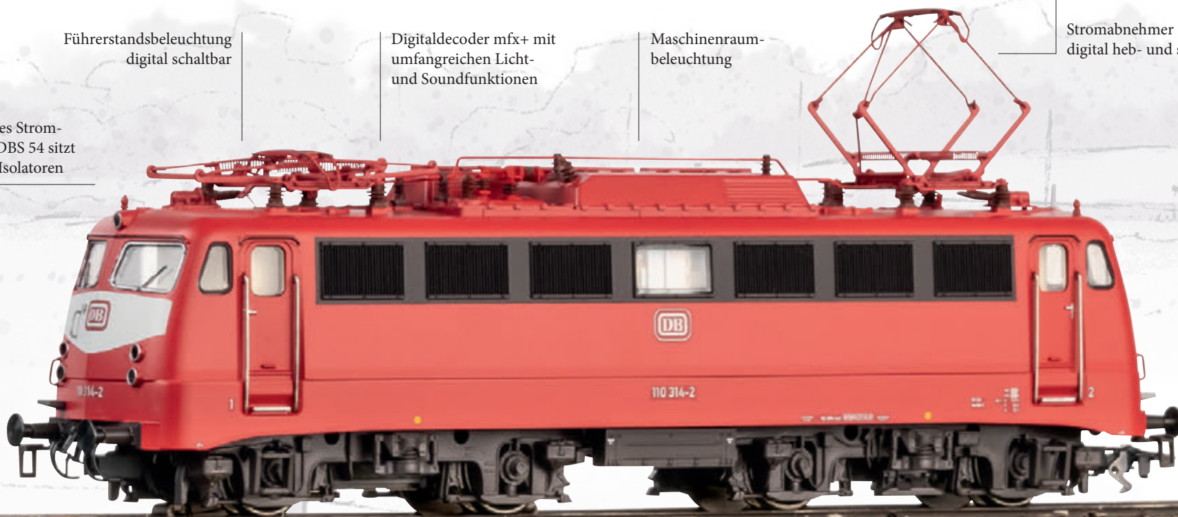
Pufferhöhe nach NEM und kinematikgeführte Kurzkupplungen
