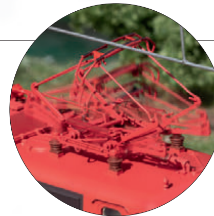
Stromabnehmer digital heb- und senkbar
