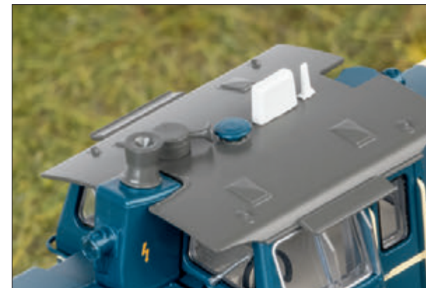
Vorbildgerechter Dachaufbau mit Signalhorn und Funkantennen
